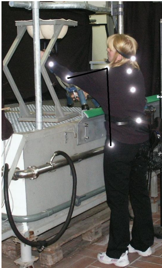
Bild 1: Probandin am Versuchsmelkstand bei der Arbeitshöhe über Schulterniveau
